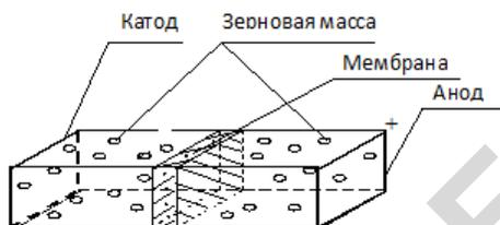
Рисунок 1 – Разделение среды с помощью мембраны
