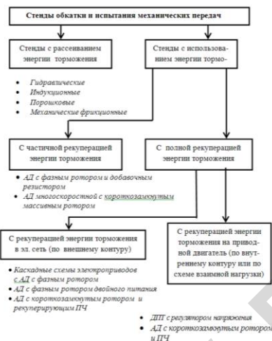
Рис. 1 – Классификация обкаточно-испытательных стендов механических передач по использованию энергии торможения при испытаниях передач под нагрузкой
