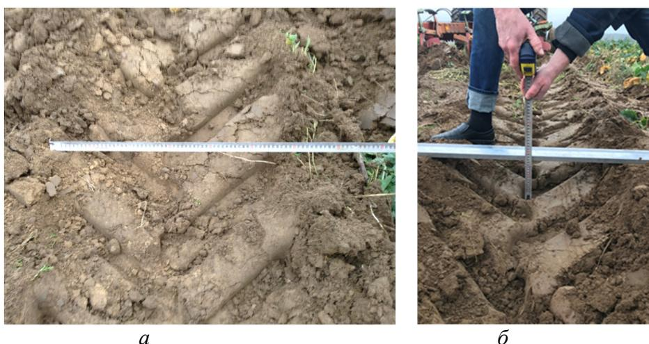
**Рисунок – Определение глубины (а) и ширины колеи (б) по следу движителя трактора «БЕЛАРУС 2022.5» с агрегатом**
