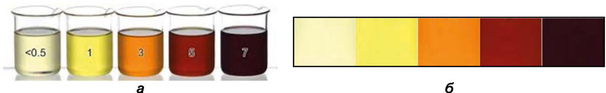
Рисунок 13. Цветовое изображение моторных масел: а – внешний вид с балльной оценкой по шкале ASTM D 1500; б – выделенные фрагменты цифровых изображений
