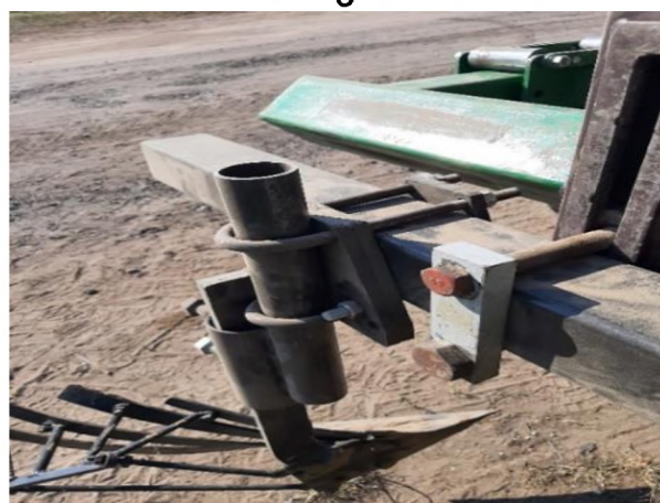
Рисунок 2. Экспериментальная установка для определения тягового сопротивления предплужников: а – 3D модель; б – общий вид; в – крепление предплужника; 1 – рама; 2 – ход колесный; 3 – устройство навесное; 4 – механизм регулировочный; 5 – площадка для грузов; 6 – опора; 7 – рамка подвижная; 8 – тензометрические датчики
