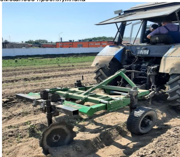
Рисунок 6. Крепление дискового предплужника на экспериментальной установке
