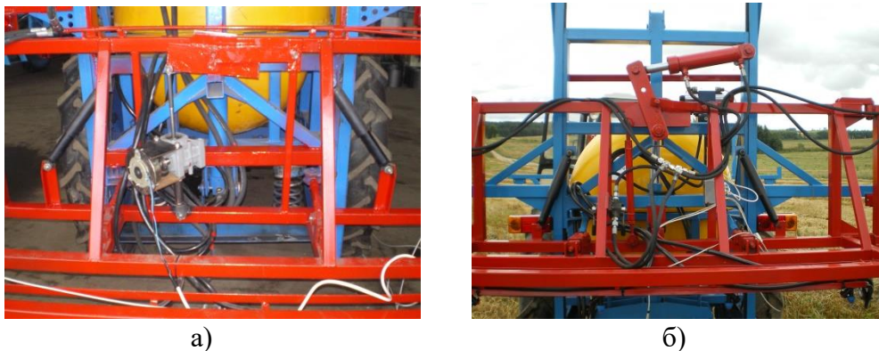
а) б) Рис. 4. Система автоматизированного управления штангой
