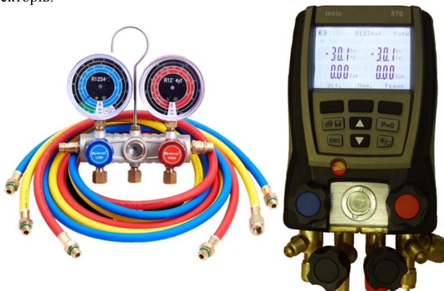
Рисунок 1 – Заправні колектори: зліва - механічний з манометрами для роботи з R1234yf і комплектом шлангів; праворуч - електронний налаштований на роботу з олефіном R1234yf
