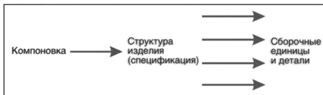
Рис. 3.2. «Нисходящий» метод создания сборок
