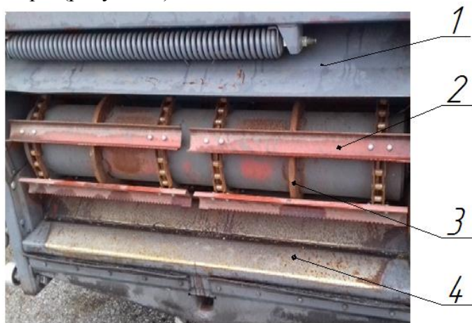
Рисунок 1 – Наклонная камера зерноуборочного комбайна: 1 - наклонная камера; 2 – планка цепочно-планчатого транспортера; 3 – стабилизирующее кольцо; 4 – рамка переходная
