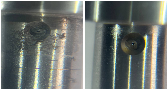
Рисунок 6 – Боковое отверстие клапана форсунки 0445120141 с эксплуатационными повреждениями (а), боковое отверстие нового клапана (б)
