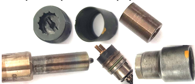
Рисунок 3 – Составляющие элементы форсунки CRIN2 (0445120141)
