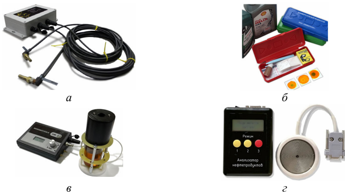
а – система контроля износа (СКИ) [2]; б – индикатор универсальный [3]; в – вискозиметр В-200М [4]; г – анализатор нефтепродуктов А-100 [5]
