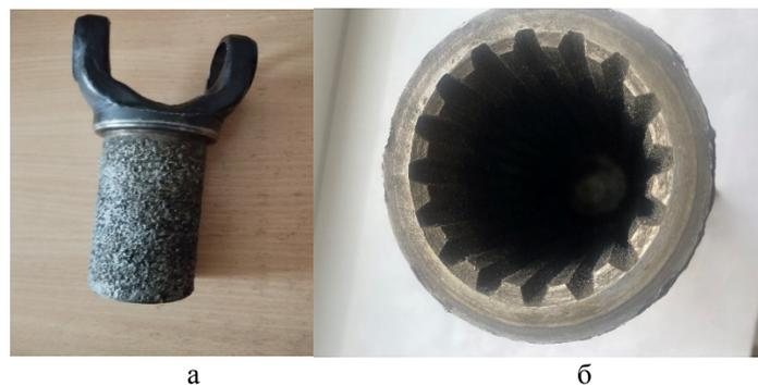
Рисунок 1 – Внешний вид (а) напыленной детали «вилка» и ее поперечное сечение (б)
