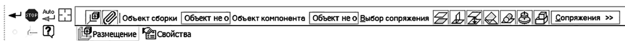
Укажите сопрягаемые объекты в компоненте и в сборке, выберите тип сопряжения для его создания
