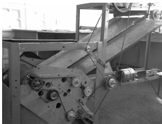
Рисунок 1 - Устройство для обрушивания семян клещевины
