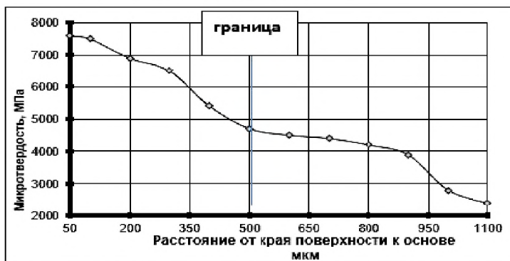
Рисунок 4 Изменение микротвердости по глубине детали «палец» после комбинированной обработки
