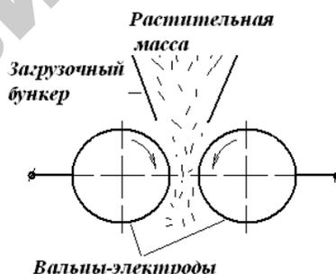
Рис. 1.8. Схема электроплазмолизатора вальцового типа
