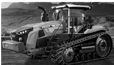
Рисунок. Серийный трактор Fendt 1100 Vario MT (а) и перспективный трактор «БЕЛАРУС 3503» (б) с гусеницами с треугольным обводом и нижним расположением ведущего колеса
