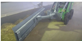
Рисунок 2 – Процесс работы подталкивателей кормов
