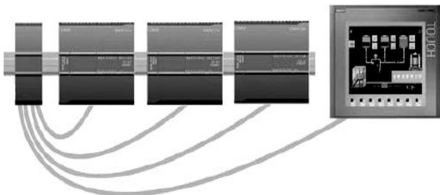
Рис. 8.2. Организация сети в составе нескольких ЦПУ и НМІ-устройств с использованием Ethernet-коммутатора
