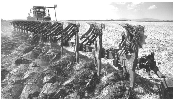
Рис. 1.5. Общий вид плуга SPF9 фирмы Gregoire Besson (Франция) с шарнирно-соединенной рамой
