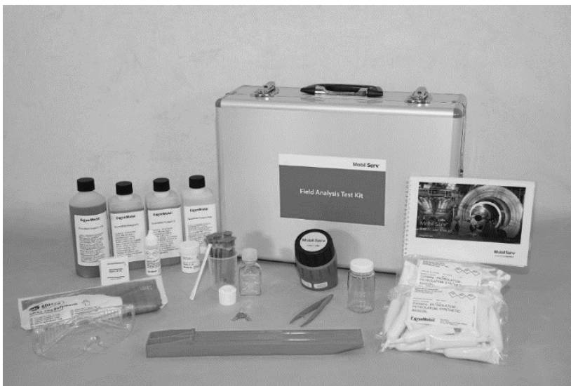
Рис. 2.6. Комплект для тестирования масел Mobil Serv Field Analysis [32]
