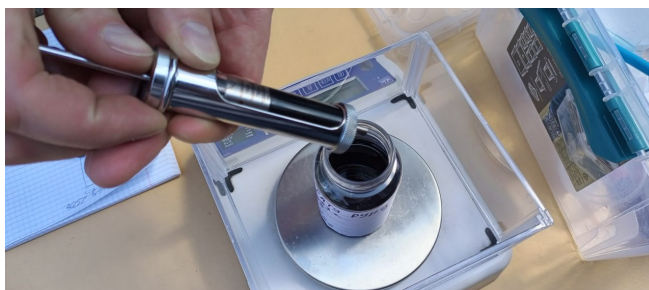
Рис. П.2. Экспресс-метод определения плотности моторного масла
