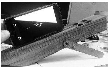
Рис. 4.9. Установка компаратора в рабочее положение
