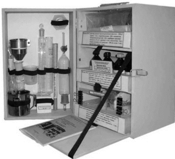
Рис. 2.2. Общий вид судовой экспресс-лаборатории топлива и масла СЛТМ [28]
