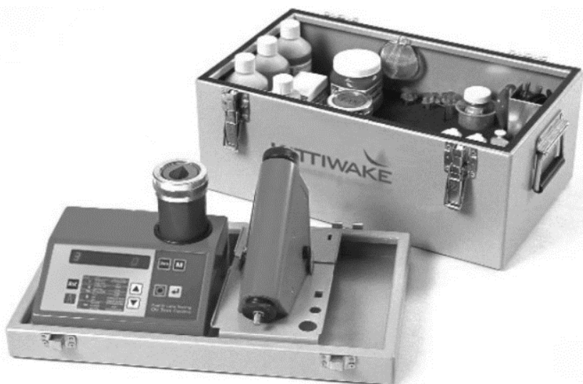
Рис. 2.4. Портативная лаборатория Kittiwake для анализа качества смазочных материалов и топлив [30]
