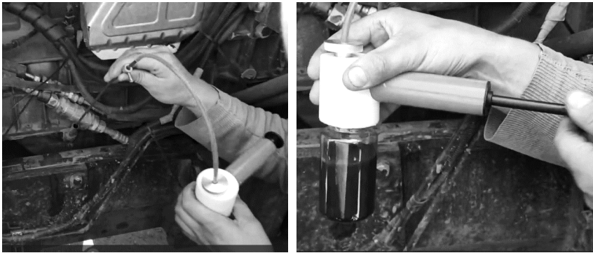
Рис. 4.2. Методика отбора проб моторного масла
