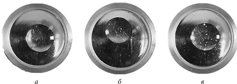
Рис. 3.6. Результаты апробации свежего моторного масла марки Лукойл Авангард 10W40 с различным количеством искусственно введенной воды: а – 0,1 %; б – 0,2 %; в – 0,4 %
