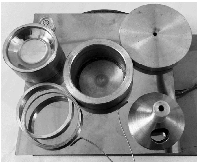
Рис. 3.4. Общий вид электротигля с набором приспособлений
