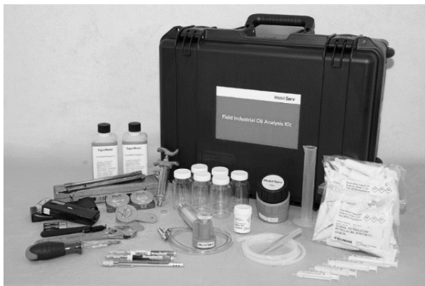
Рис. 2.7. Комплект для анализа промышленных масел Mobil Serv Field [33]
