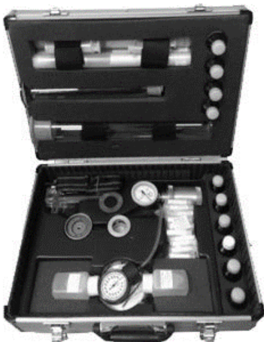
Рис. 2.1. Портативная лаборатория анализа масел и топлив ПЛАМ [27]
