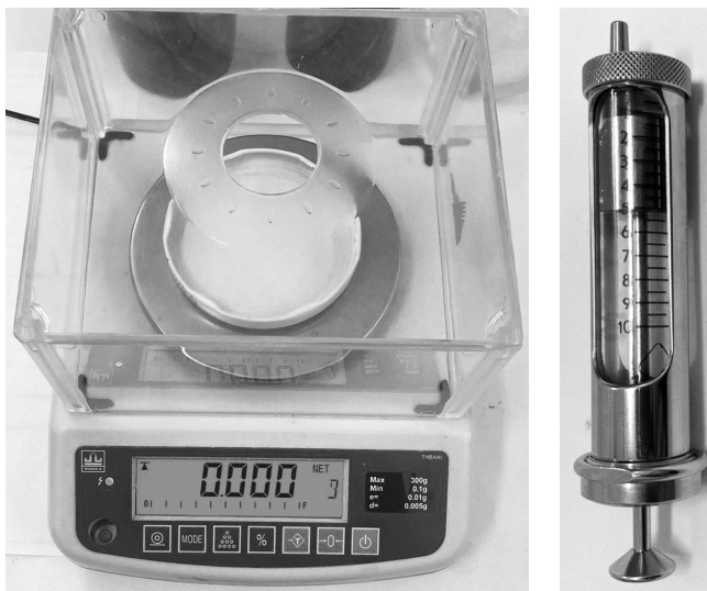
Рис. 4.5. Оборудование и приспособления для экспресс-метода определения плотности моторного масла: а – весы ВК-300; б – стеклянный шприц
