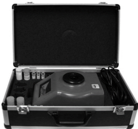
Рис. 2.5. Комплект Kittiwake FGK14144PA ANALEXfdMplus для оценки продуктов металлического износа [31]
