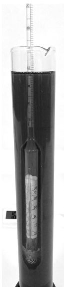
Рис. 4.4. Определение плотности при помощи ареометра АНТ-2 650–1070 ГОСТ 18481–81
