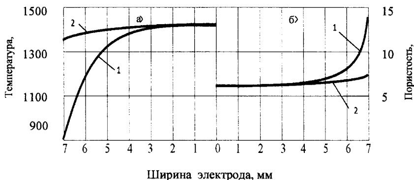
Рис. 4. Распределение температуры (а) и пористости (б) по ширине электрода: 1 – обычный электрод; 2 – комбинированный электрод
