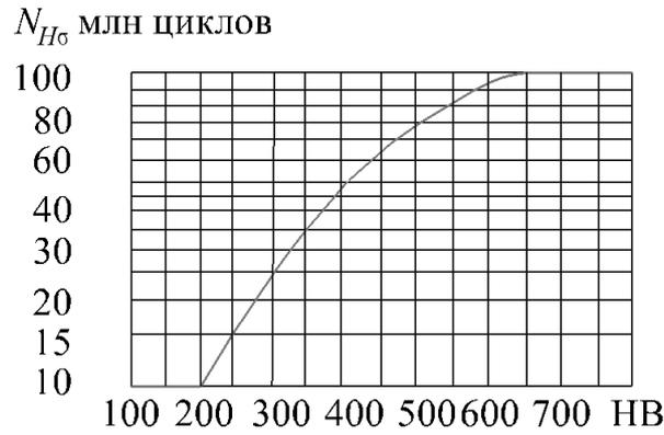
Рис. 3.29. График определения базового числа циклов изменения напряжения  $N_{H\sigma}$
