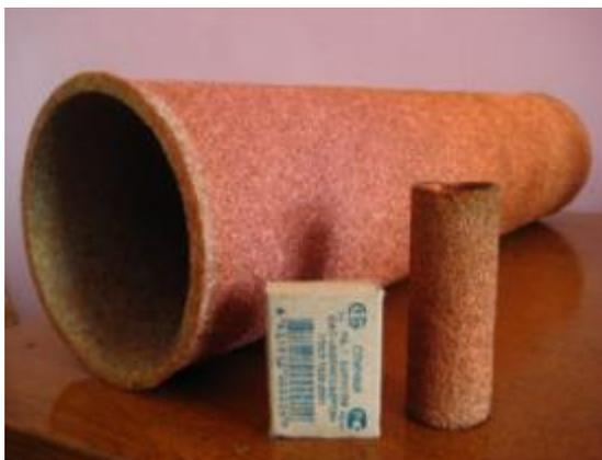
Рис. 3. Крупногабаритный ФЭ, изготовленный методом сухого изостатического прессования из медных волокон
