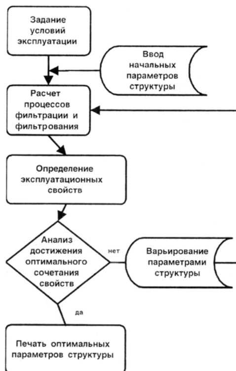
Рис. 27. Блок-схема процесса определения оптимального порораспределения ППМ
