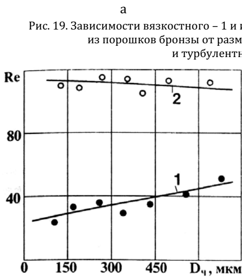
Рис. 20. Зависимость критических чисел Рейнольдса при переходе от ламинарного режима к переходному - 1 и от переходному к турбулентному - 2 от размеров частиц ППМ из порошков бронзы
