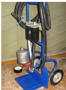
Рис. 2. Фотография малогабаритной системы очистки рабочих жидкостей гидравлических систем
