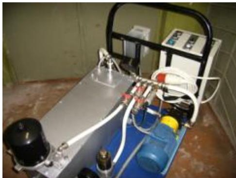
Рис. 1. Фотография мобильной установки для очистки отработанных моторных и гидравлических масел
