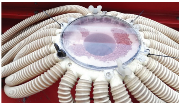
Рис. 1. Выпадение гранулированных удобрений в нижней части распределительной головки
