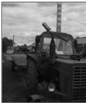
Рисунок 3 – Искрогаситель (выхлопная система МТЗ-80)
