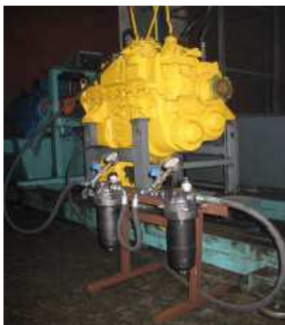
Рис. 5. Внешний вид установки для циркуляционной очистки и гомогенизации рабочей жидкости при обкатке ГКПП.
