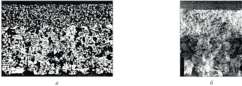
Рис. 2. Микроструктура шлифа (а) и излома (б) образца двухслойного ФМ из порошка титана марки ТПП
