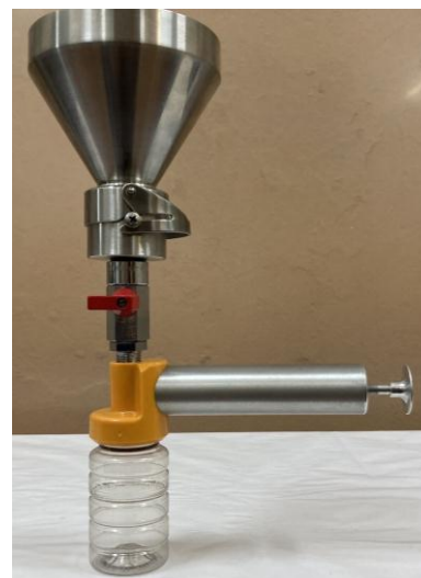
Рисунок 2 – Внешний вид установок для патч-тестирования: a – для лабораторных испытаний; б – для полевых испытаний
