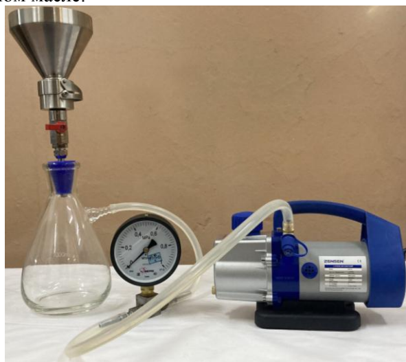
Рисунок 2 – Внешний вид установок для патч-тестирования: a – для лабораторных испытаний; б – для полевых испытаний
