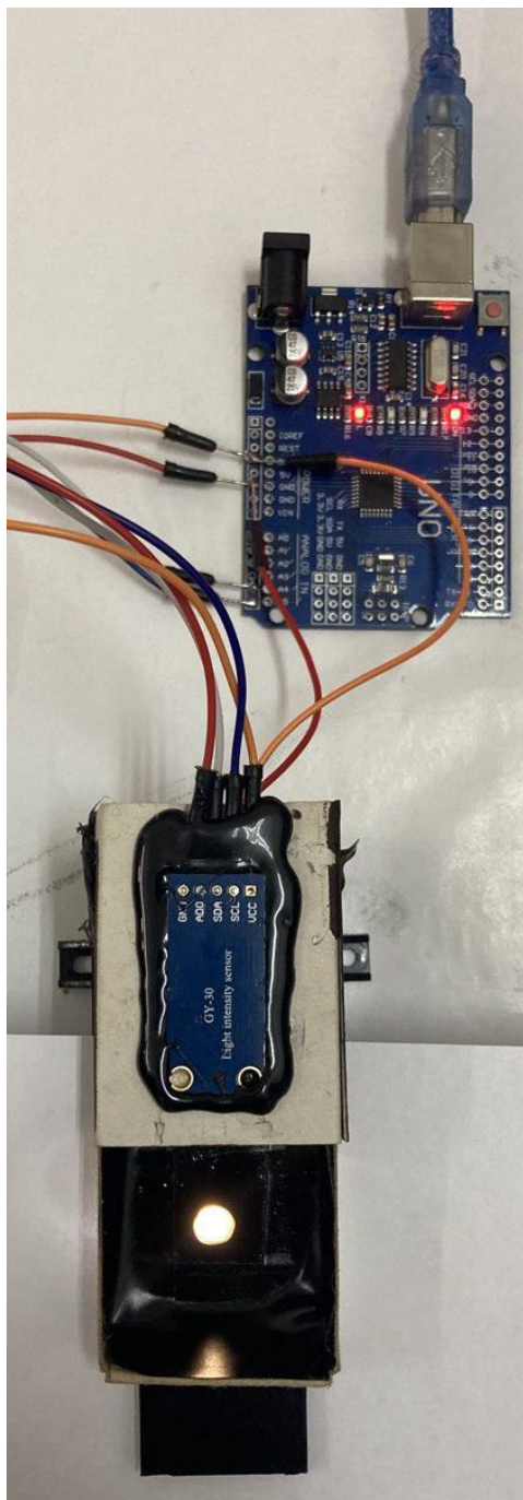
Рисунок 3 – Фотометр: а – внешний вид устройства; б – пример результатов экспериментальных данных, полученных на мониторе компьютера
