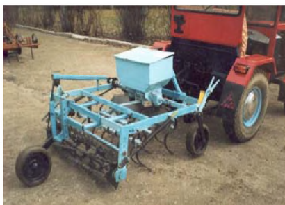
Рисунок 1 - Схема комбинированного почвообрабатывающего агрегата: 1 – опорно-регулируемый каток; 2 – навесное устройство; 3 – рама; 4 – туковысевающий аппарат; 5 – тукораспределитель; 6 – рыхлительная секция; 7 - S-образный зуб; 8 – пружинный механизм; 9 – универсальный каток; 10 – цепная передача; 11 – сектор; 12 – подвеска рыхлительной секции; 13 – стойка; 14 – опорный каток.
