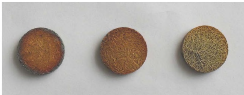
Рисунок 1 - Образцы фильтроэлементов, изготовленных из жаростойкой латуни
