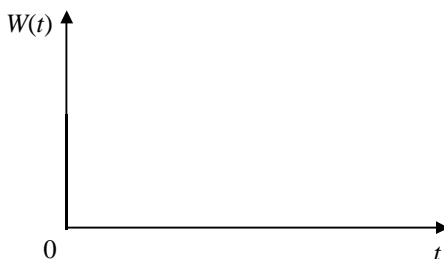
Рис. 6.2. График импульсной переходной функции безынерционного звена
