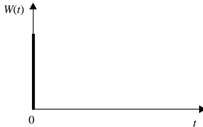
Рис. 6.31. График импульсной переходной функции дифференциального звена
