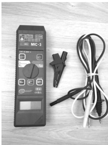
Рис. 3.7. Мегаомметры: а – мегаомметр ЭС0202/1Г; б – измеритель сопротивления MIC-3
