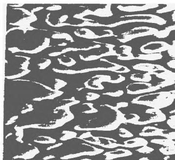
Рисунок 2 - Топография поверхности стальных образцов после нанесения алюминиевого покрытия и обработки ионами
