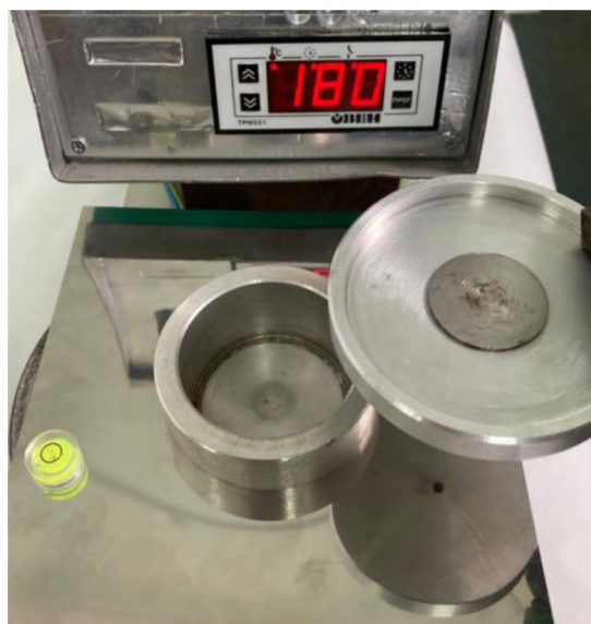
Рисунок 1. Электротигель для реализации экспресс-теста определения наличия и количества топлива в моторном масле
