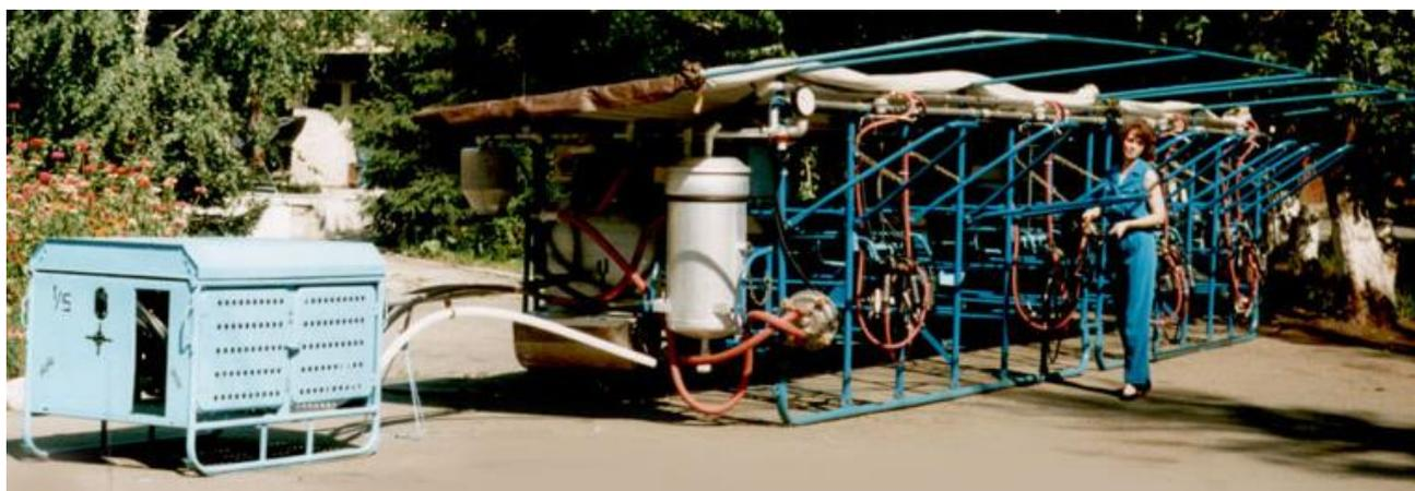
**Рисунок 2.73 – Универсальная доильная станция УДС-3Б**
