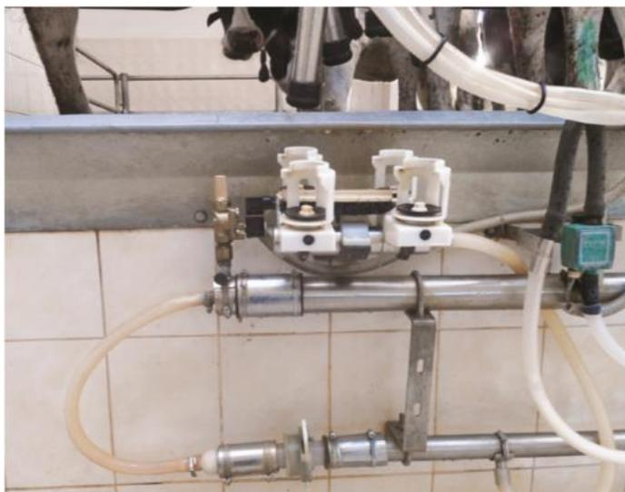
**Рисунок 2.85 – Место соединения молокопровода с линией промывки**
