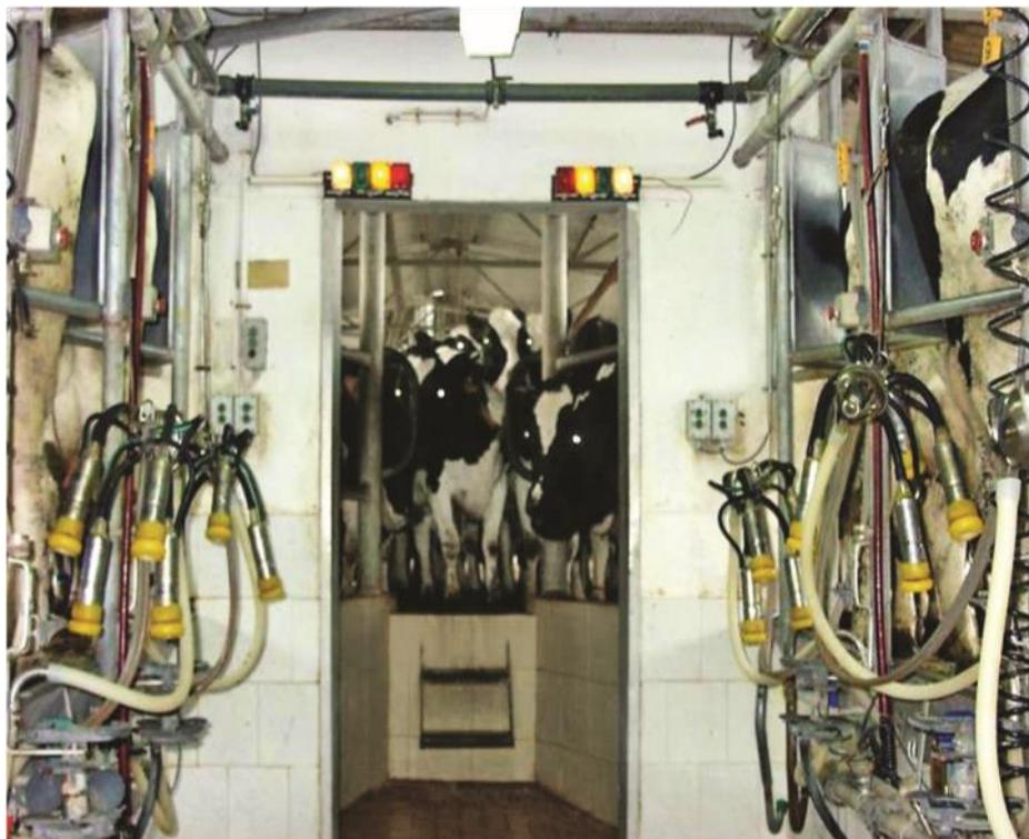
Рисунок 2.90 – Световая сигнализация доильного зала
