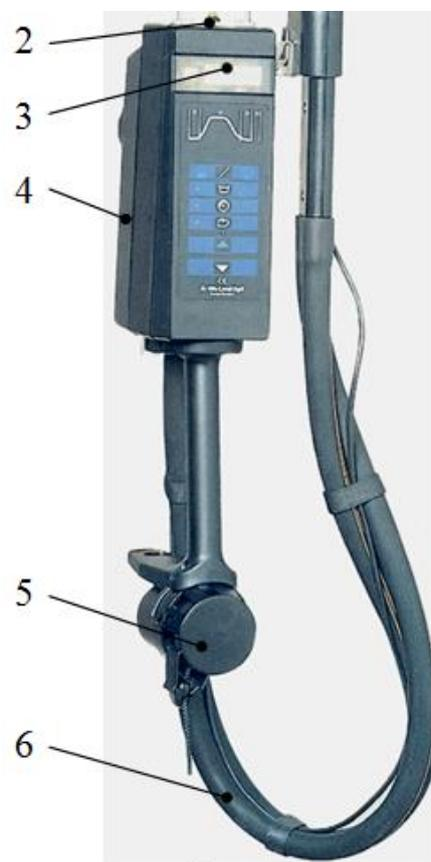
1 – молочно-вакуумный кран; 2 – лампочка; 3 – дисплей; 4 – блок управления; 5 – автоматический съемник доильных стаканов; 6 – шланги
