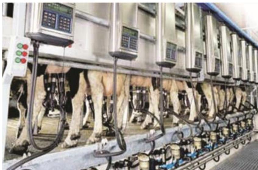
**Рисунок 2.61 – Доильная установка «Параллель» фирмы «DeLaval»**
