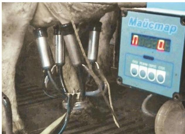
**Рисунок 3.12. – Доение в режиме «П» (полуавтоматическом)**
