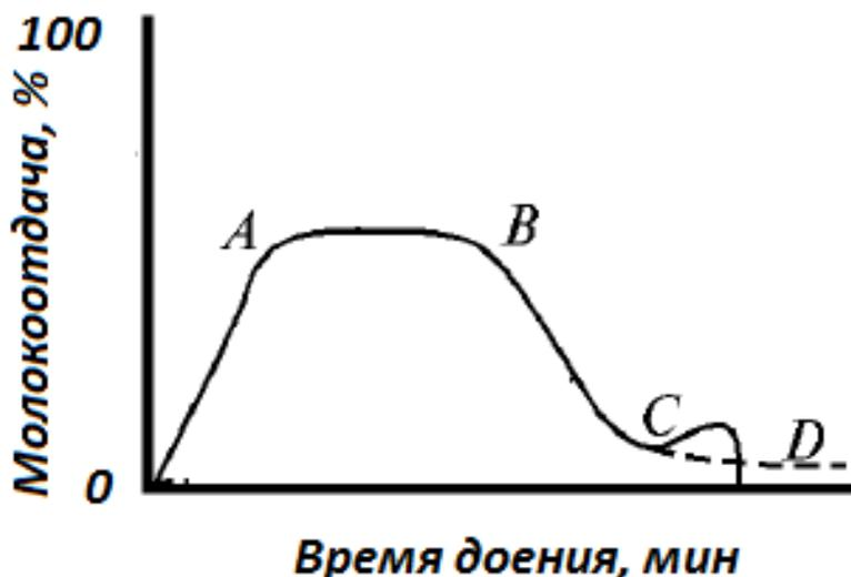
*OA – конец скрытого периода; AB – период активного припуска молока; BC – окончание припуска; CD – вторичный припуск при машинном додаивании*
