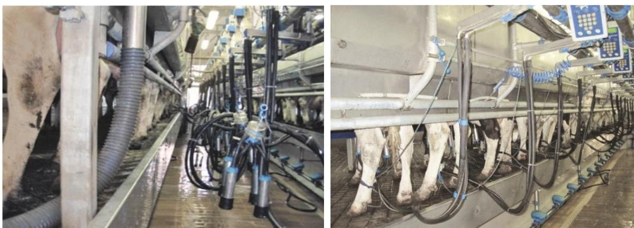
**Рисунок 2.62 – Доильная установка «Параллель» фирмы «Dairymaster»**
