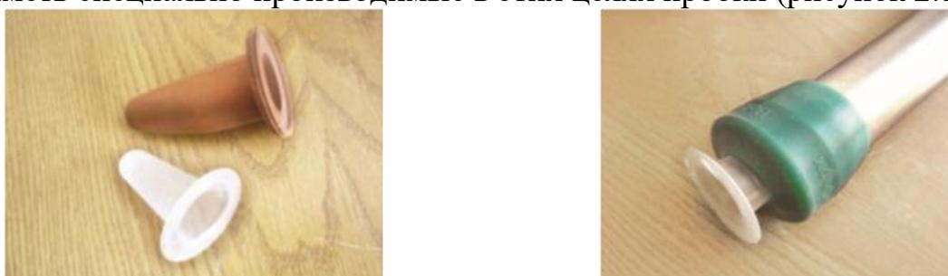
**Рисунок 2.18 – Пробка для герметизации входного отверстия головки сосковой резины**
