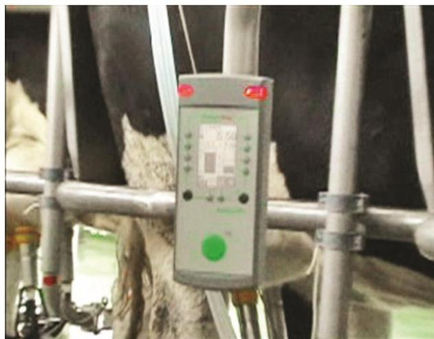
**Рисунок 3.6 – Пульт управления и индикации параметров доения**
