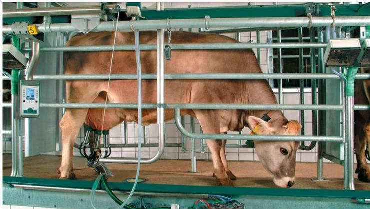
**Рисунок 2.49 – Доильный зал AutoTandem компании GEA**
