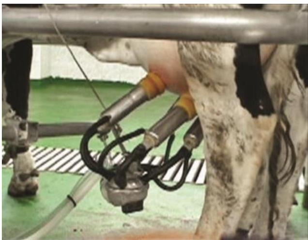
**Рисунок 3.7 – Автоматическое снятие подвесной части доильного аппарата вымени**
