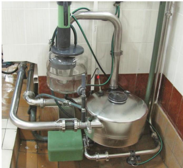
**Рисунок 2.84 – Молокоприемный узел с системой защиты от перелива**
