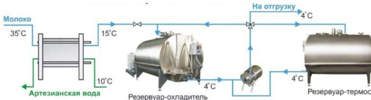
**Рисунок 4.8 – Комбинированная система охлаждения молока**
