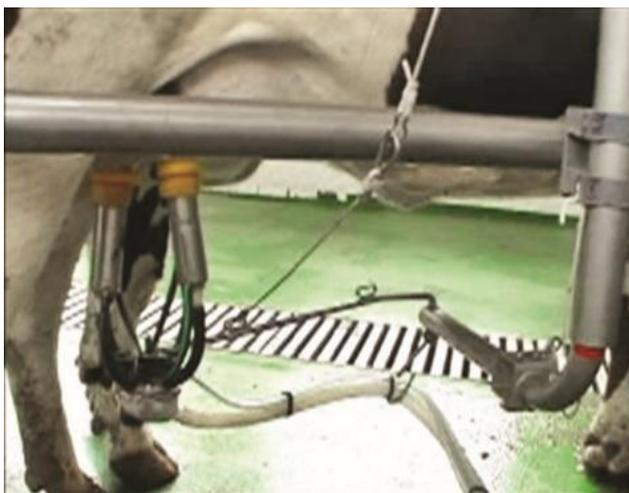
**Рисунок 3.5 – Правильное положение подвесной части доильного аппарата**
