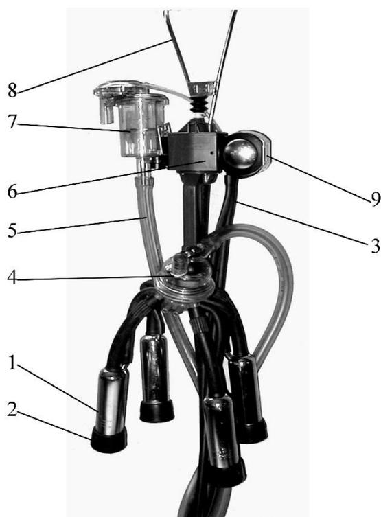
1 – доильный стакан; 2 – сосковая резина; 3 – шланги переменного вакуума; 4 – коллектор; 5 – молочный шланг; 6 – блок управления; 7 – приемник; 8 – скоба; 9 – пульсатор
