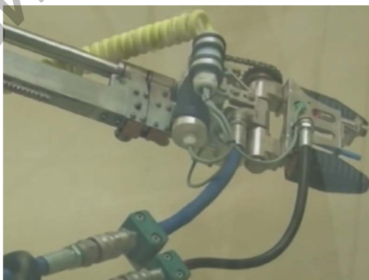
Рис. 3. Устройства внутренней очистки бункеров от «Silo-RoBoFox»: схема конструкции (а) и манипулятор с гидравлическими насадками (б)
