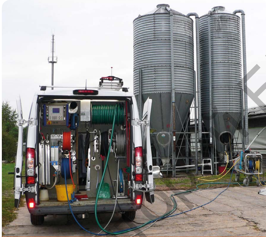
Рис. 2. Общий вид передвижного пункта для внутренней очистки силосов (Silo-RoBoFox, Германия)
