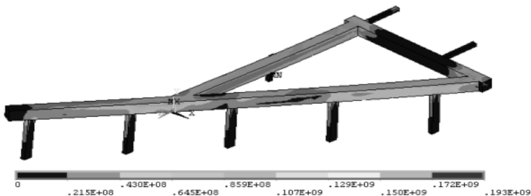
Рисунок 2. Карта эквивалентных напряжений по Мизесу
