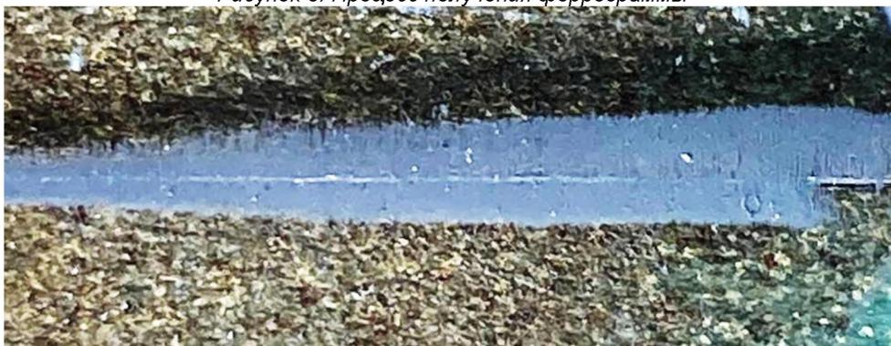
Рисунок 6. Фрагмент полученной феррограммы моторного масла Shell 10W40 с наработкой 250 ч
