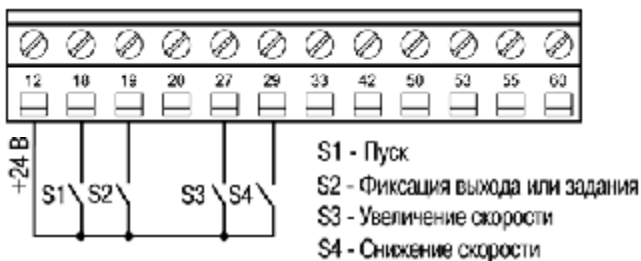
Рис. 10.8. Схема подключений для конфигурации «Управление скоростью АД при помощи цифровых входов»
