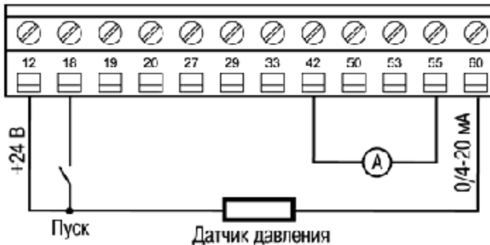
Рис. 10.12. Схема подключений для конфигурации «поддержание заданного давления»
