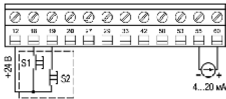
Рис. 10.11. Схема подключений конфигурации «Управление скоростью и инверсной характеристикой»
