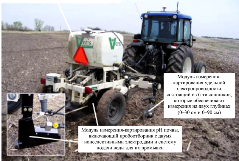
Рис. 2.18. Передвижная сенсорная платформа Veris
