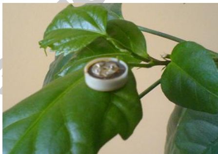
Рис. 2.23. Сенсор контроля потребности растений во влаге в полевых условиях, размещаемый на листьях растений
