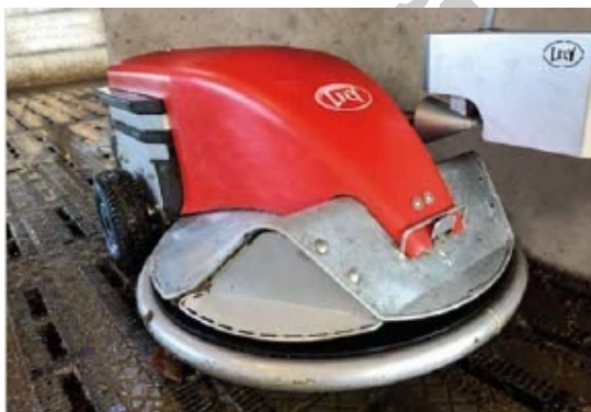
Рис. 2.77. Навозоуборочный робот Discovery
