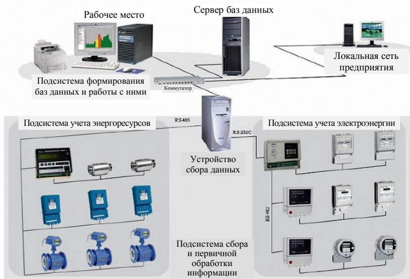
Рис. 5.3. Структурная схема АСКУЭ производственного предприятия
