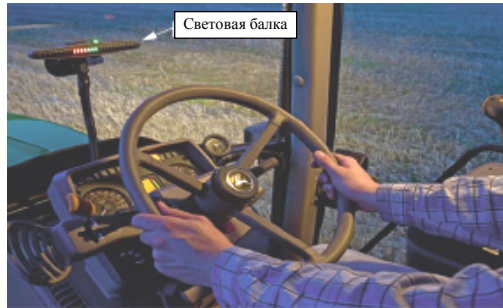
Рис. 2.7. Ручное управление машиной с помощью световой балки
