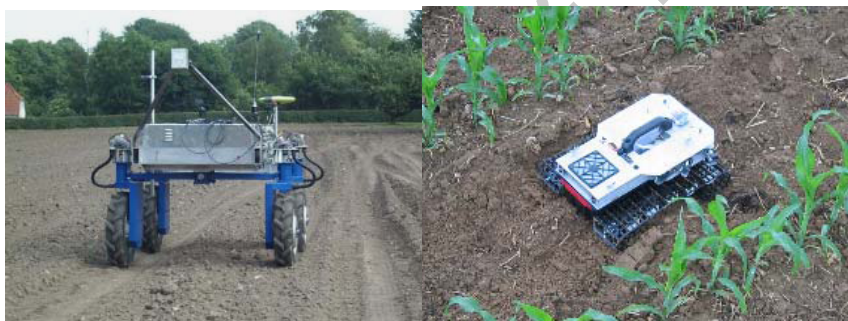
Рис. 2.40. Портальная платформа для автоматизированного контроля состояния растений (Датский технический университет) (слева); робот, расположенный ниже уровня растительного покрова (Гогенгеймский университет, Германия) (справа)
