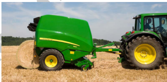
Рис. 2.4. Трактор и пресс-подборщик с системой ISOBUS
