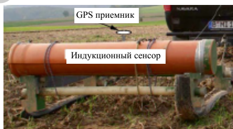
Рис. 2.20. Измерение электропроводности почвы с помощью электромагнитной индукции в режиме реального времени в процессе движения
