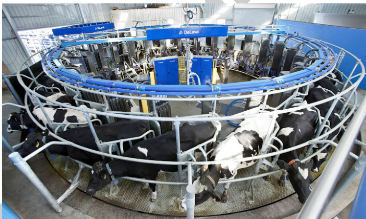
Рис. 2.74. Роботизированная доильная «карусель» AMR
