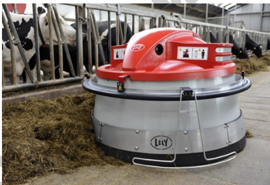
Рис. 2.68. Подравнивание кормов в коровнике с помощью робота Juno
