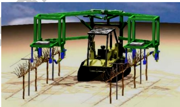
Рис. 2.47. Робот для обрезки виноградной лозы фирмы Vision Robotics
