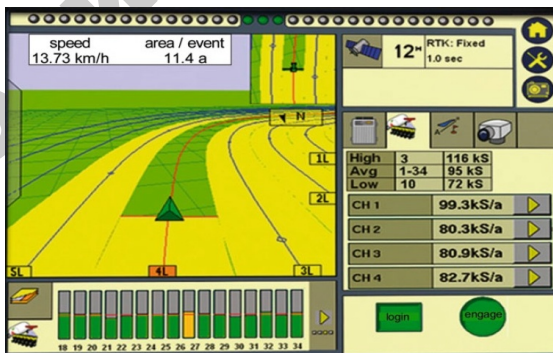
Рис. 2.8. Дисплей пользовательского интерфейса к автоматической системе управления
