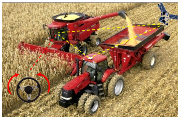
Рис. 2.11. Синхронизация работы машин с помощью системы V2V
