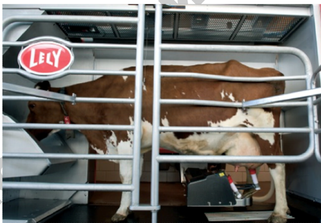
Рис. 2.72. Доильный бокс робота Astronaut A4
