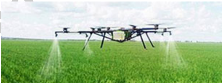
Рис. 2.52. Опыление посевов с помощью беспилотного летательного аппарата
