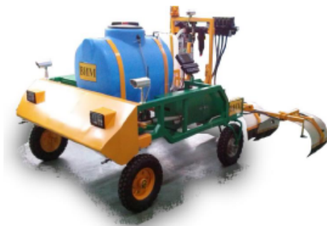
Рис. 2.46. Роботизированный опрыскиватель для низкорастущих ягодных культур
