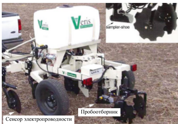
Рис. 2.30. Оборудование Veris для одновременного контроля рН и электропроводности почвы
