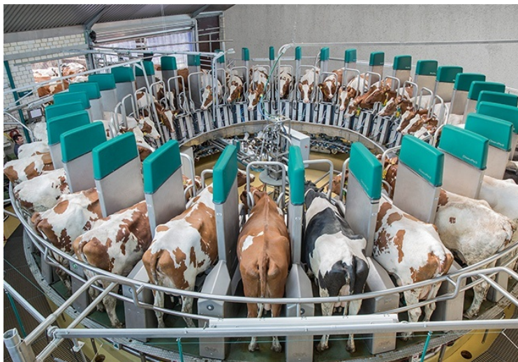
Рис. 2.75. Роботизированная «карусель» DairyProQ
