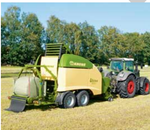
Рис. 2.5. Пресс-подборщик-обмотчик Ultima Non-Stop
