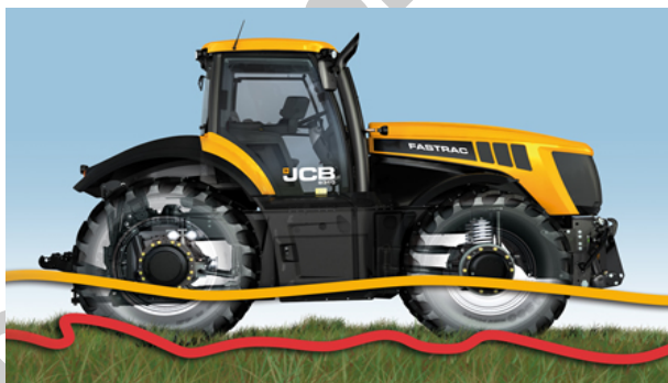
Рис. 2.1. Трактор Fastrac с активной системой амортизации
