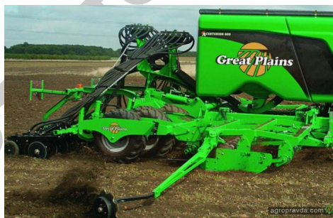
Рис. 2.26. Сеялка Centurion-600 с системой регулировки заглубления культиваторных дисков
