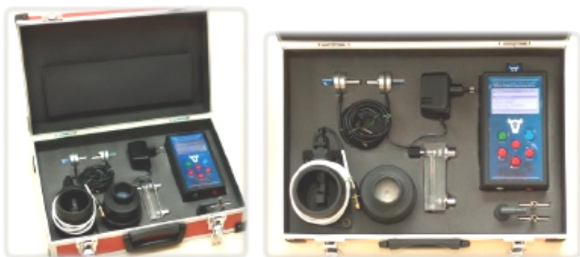
Рис. 3.4. Общий вид комплекта приборов для контроля технических параметров молочно-доильного оборудования
