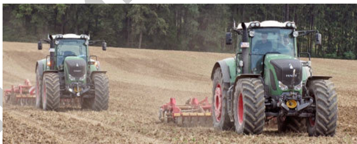
Рис. 2.12. Синхронизация работы тракторов с помощью системы Guide Connect
