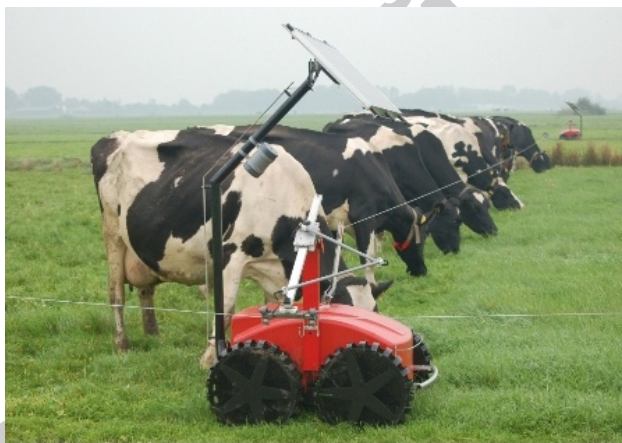
Рис. 2.70. Робот-пастух автоматической пастбищной системы Voyager
