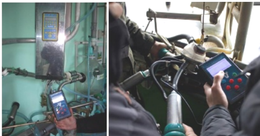
Рис. 3.5. Применение комплекта приборов для контроля технических параметров молочно-доильного оборудования в производственных условиях
