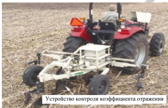
Рис. 2.21. Одновременное картирование коэффициентов отражения излучения ближней инфракрасной части спектра в нижней части культиватора и электропроводностей контактным методом
