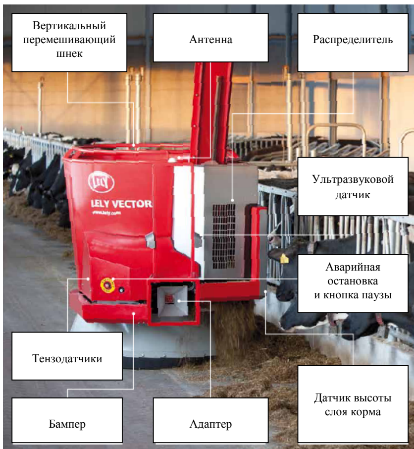
Рис. 2.67. Роботизированная система смешивания и подачи корма Vector
