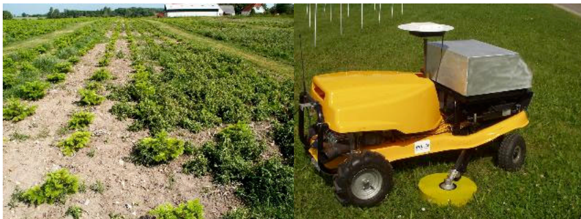
Рис. 2.43. Молодые новогодние елочки с фрагментами сорняков (слева). Автономный пропальщик новогодних елок, оснащенный боковым резакom и системой управления на основе GPS (справа)
