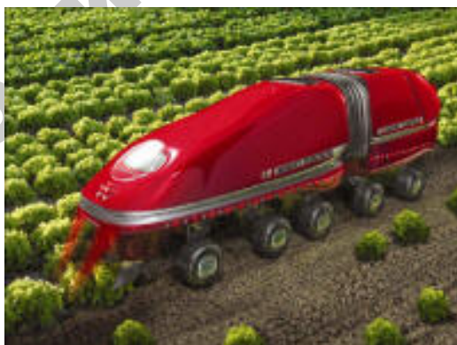
Рис. 2.50. Робот для выборочной уборки урожая фирмы Massey Ferguson
