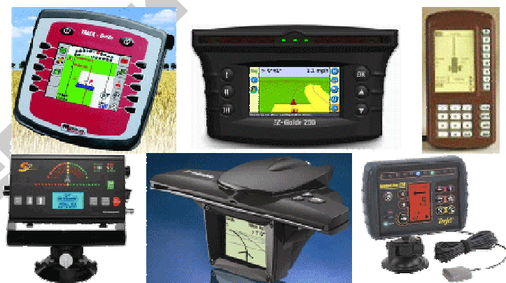
Рис. 2.10. Внешний вид систем параллельного вождения машин
