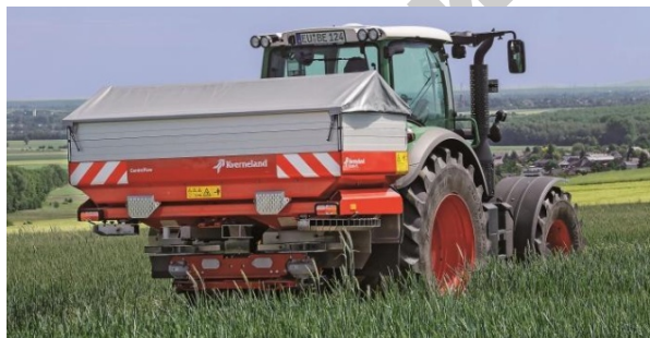
Рис. 2.34. Разбрасыватель удобрений с системой управления Spread Control
