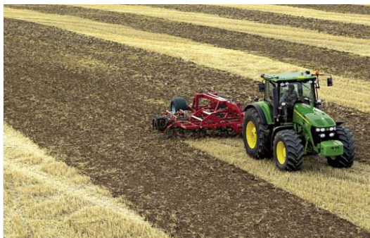
Рис. 2.9. Параллельное движение трактора по полю с помощью системы Parallel Tracking
