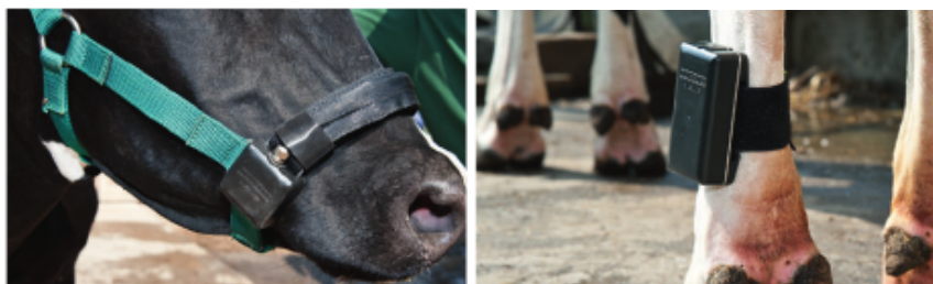
Рис. 2.61. Система мониторинга состояния здоровья коров RumiWatch: сенсор жевательных движений (слева) и сенсор-шагомер
