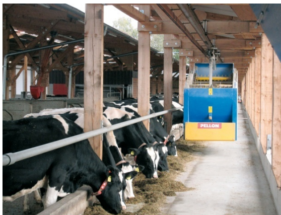
Рис. 2.66. Подача кормов в коровнике с помощью робота Pellon TMR
