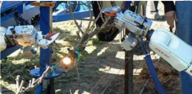
Рис. 2.48. Процесс роботизированной обрезки виноградной лозы выдвигаемыми ножницами
