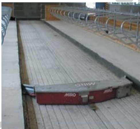
Рис. 2.76. Навозоуборочный робот Scarabeo
