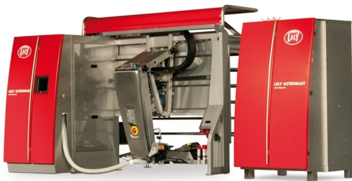
Рис. 2.71. Роботизированная доильная установка Astronaut A4
