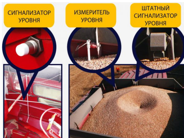
Рис. 2.36. Сенсорный контроль уровня сыпучих материалов в бункере комбайна
