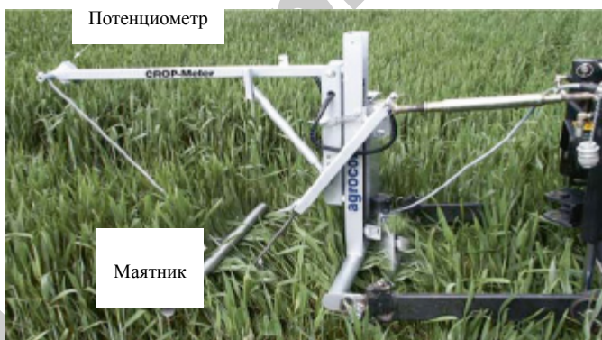
Рис. 2.33. Контроль сопротивления покрова злаковых культур изгибам с помощью маятника, который установлен перед трактором
