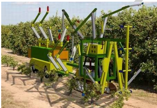
Рис. 2.51. Робот фирмы Vision Robotics для сбора апельсинов
