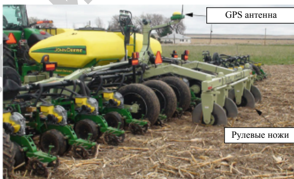
Рис. 2.13. Активное управление сеялкой на боковом откосе. GPS-антенна на крыше трактора не видна
