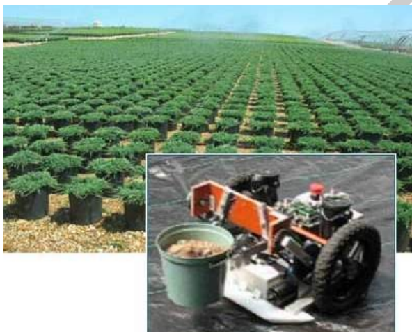
Рис. 2.38. Робот фирмы Q Robotics для высадки рассады в горшках
