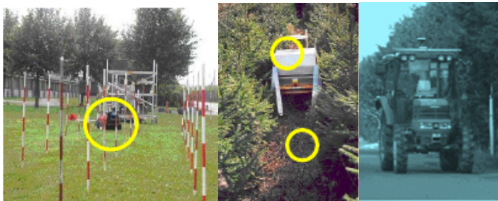
Рис. 2.44. Робот картирует модельные деревья (слева); робот-пропольщик срезает траву под елками (в центре); роботизированный трактор сканирует зрелые деревья (справа)
