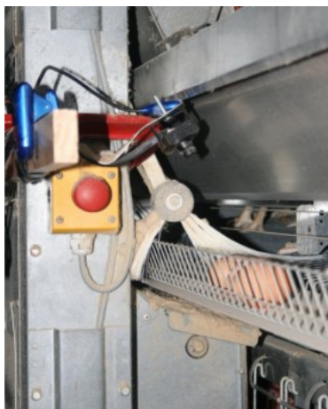
Рис. 2.83. Система компьютерного зрения для контроля яиц во избежание их возможных блокировок при движении на конвейере
