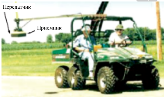
Рис. 2.27. Контроль поверхностной отражательной способности почвы с использованием радара
