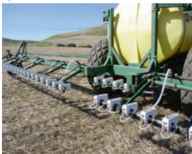
Рис. 2.22. Консоль разбрызгивателя с оптическими сенсорами для капельного опрыскивания сорняков на невозделанном поле
