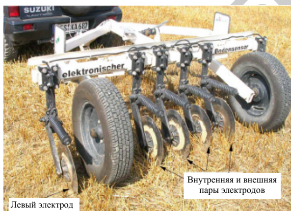
Рис. 2.19. Измерение электропроводности почвы контактным методом, система Veris. Правый токовый электрод скрыт за колесом
