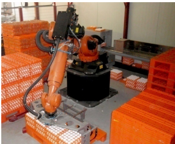
Рис. 2.84. Робот-штаблер Cobot для загрузки яиц в лотки
