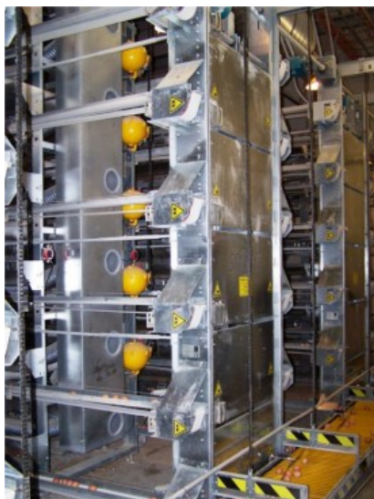
Рис. 2.82. Роботизированная шестиуровневая установка с лифтовой системой для сбора яиц
