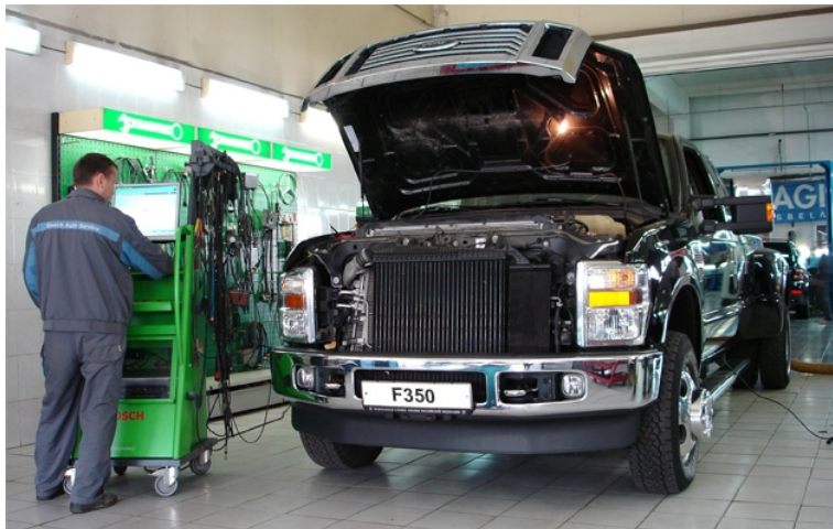
Рис. 3.6. Компьютерная диагностика двигателя в сервисном центре
