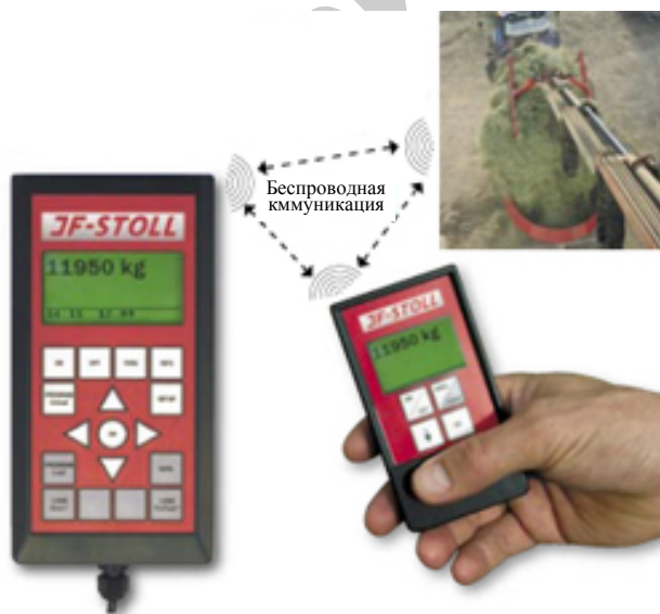
Рис. 2.63. Схема беспроводной связи терминалов системы Feed Manager
