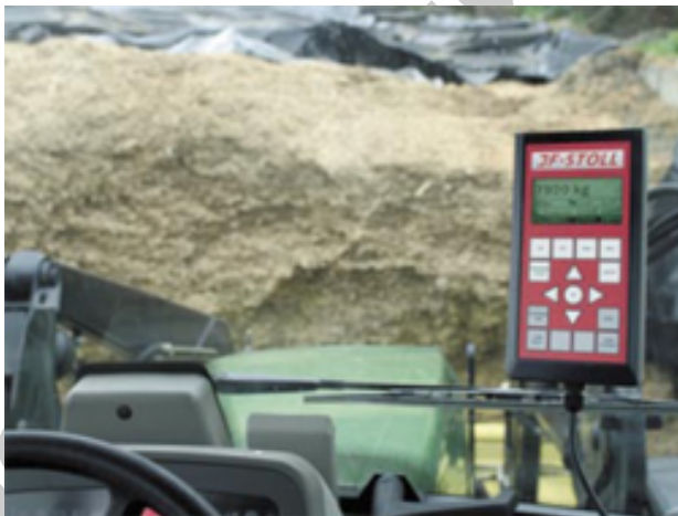
Рис. 2.64. Дисплей главного терминала системы Feed Manager, установленный в кабине смесителя-кормораздатчика Feeder VM
