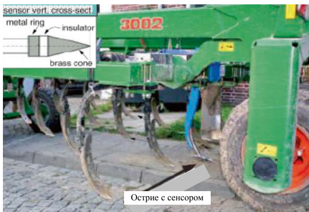
Рис. 2.28. Схема емкостного контроля на наконечнике зуба культиватора. Вставка сверху слева – вертикальное сечение сенсора. Частота электрического тока 100 ГГц
