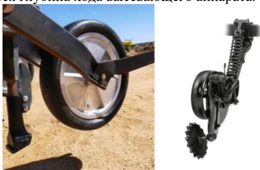
Рисунок 2 – Сошник ConservaPak сеялки John Deere 1870 (слева), сошник ProSeries сеялки John Deere 1890 (справа)
