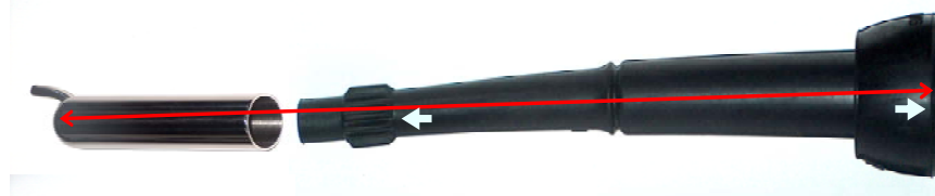
Постановка сосковой резины в доильный стакан
