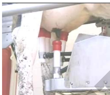
Установка доильных стаканов на соски вымени
