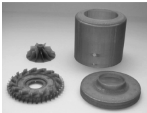
Рисунок 5.18 - Детали из термостойких пластиков, изготовленные с помощью FDM-технологии
