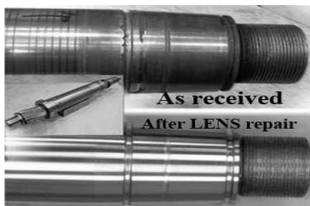
Рисунок 4.23 - Сравнение вала, восстановленного газотермическим напылением (вверху) и LENS-технологией
