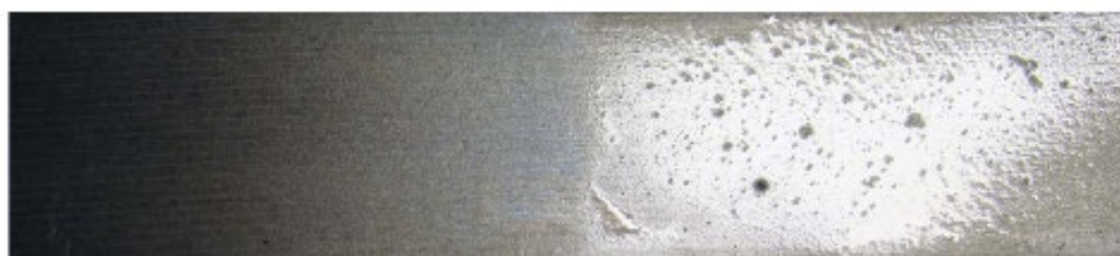
Рисунок 6.3 - Лазерная очистка стальной полосы от масляной пленки (слева–очищенная часть)
