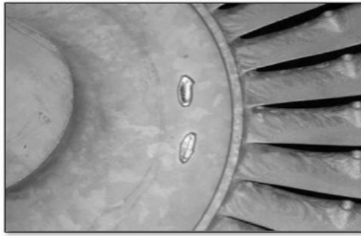
Рисунок 4.16 - Устранение литейных дефектов в виде пор на поверхности колеса. Основа колеса выполнена из никелевых/титановых сплавов, наплавка – из того же материала
