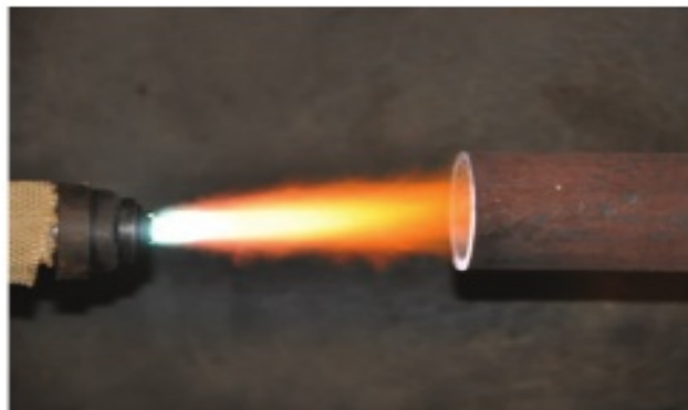
Рисунок 6.11 - Плазматрон внутренней очистки вводят в трубу на всю ее длину
