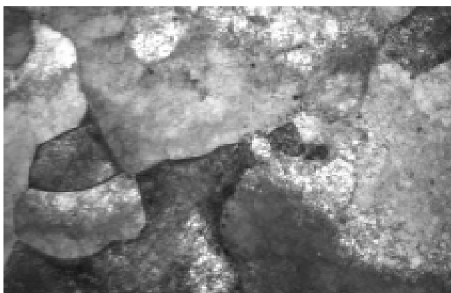
Рисунок 4.5 - Структура приграничного слоя в никеле при электровзрывном науглероживании (кристаллиты \text{Ni}_3\text{C} )
