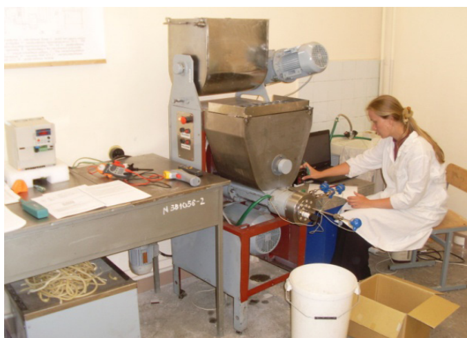
Рисунок 4 – Проведение экспериментальных исследований на малом макаронном прессе МИТ-2
