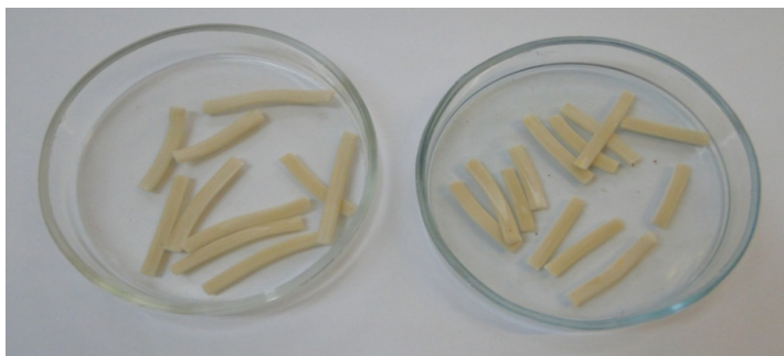
Рисунок 5 – Образцы полученных при испытаниях макаронных изделий (слева – с использованием специальных вставок; справа – без вставок)
