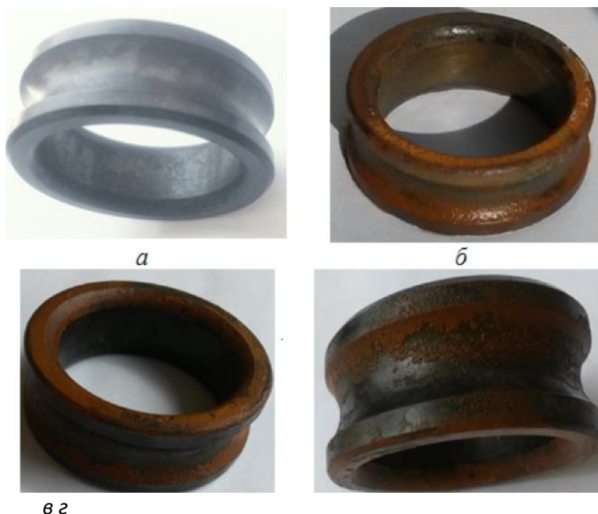
а – до начала эксперимента, б – через 120 часов, в – через 192 часов, г – через 288 часов Рисунок 3. Фотографии образцов внутреннего кольца подшипника, обработанного методом MAO и подвергнутый испытанию через определенное время
