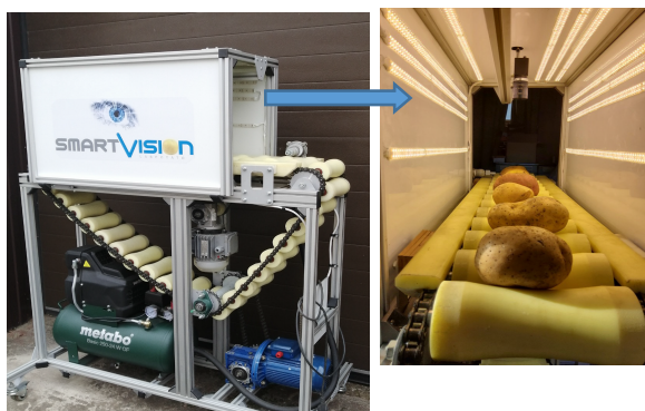
Рисунок 3. – Макетный образец автоматической сортировальной машины
